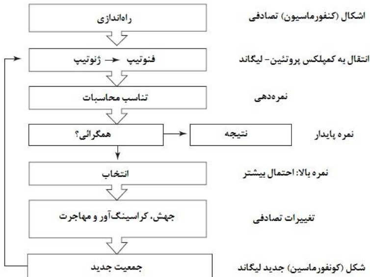
شکل ۵-۷) الگوریتم ژنتیک استفاده شده توسط نرم افزار GOLD
