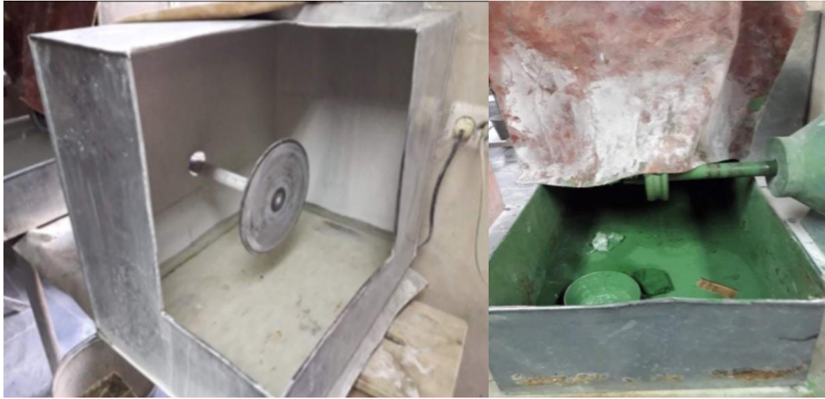
در عکس های فوق ماشین های پالش سنگ و برش سنگ را مشاهده می فرمایید.
